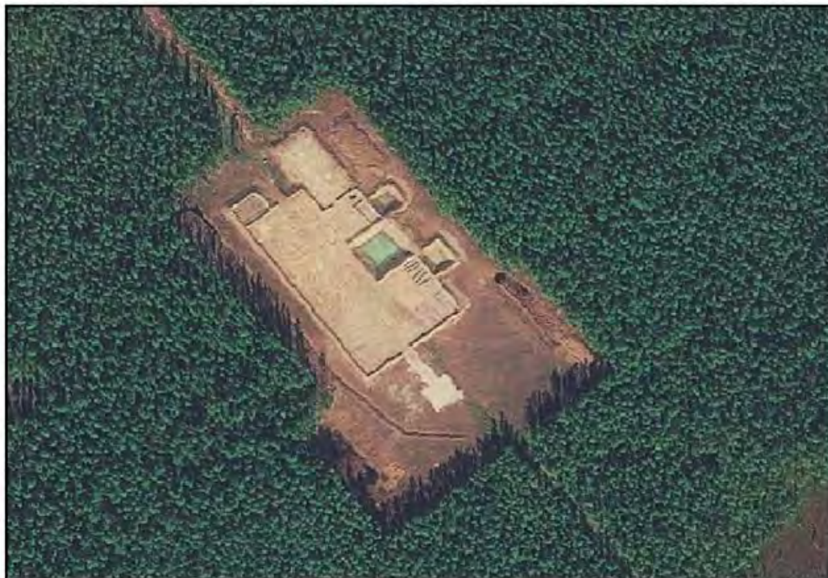
Рисунок 1 – Современная конструкция существующей площадки скважины со шламовым амбаром
