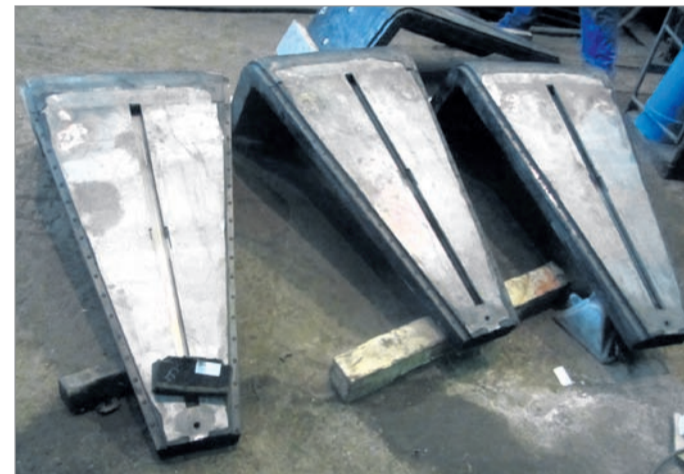
Так выглядят подготовленные к монтажу брони торцевой стенки мельницы
