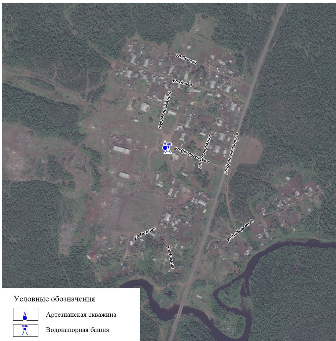
Рисунок 2 - Технологическая зона водоснабжения с указанием зоны обслуживания децентрализованной системы холодного водоснабжения п. Бадарма
