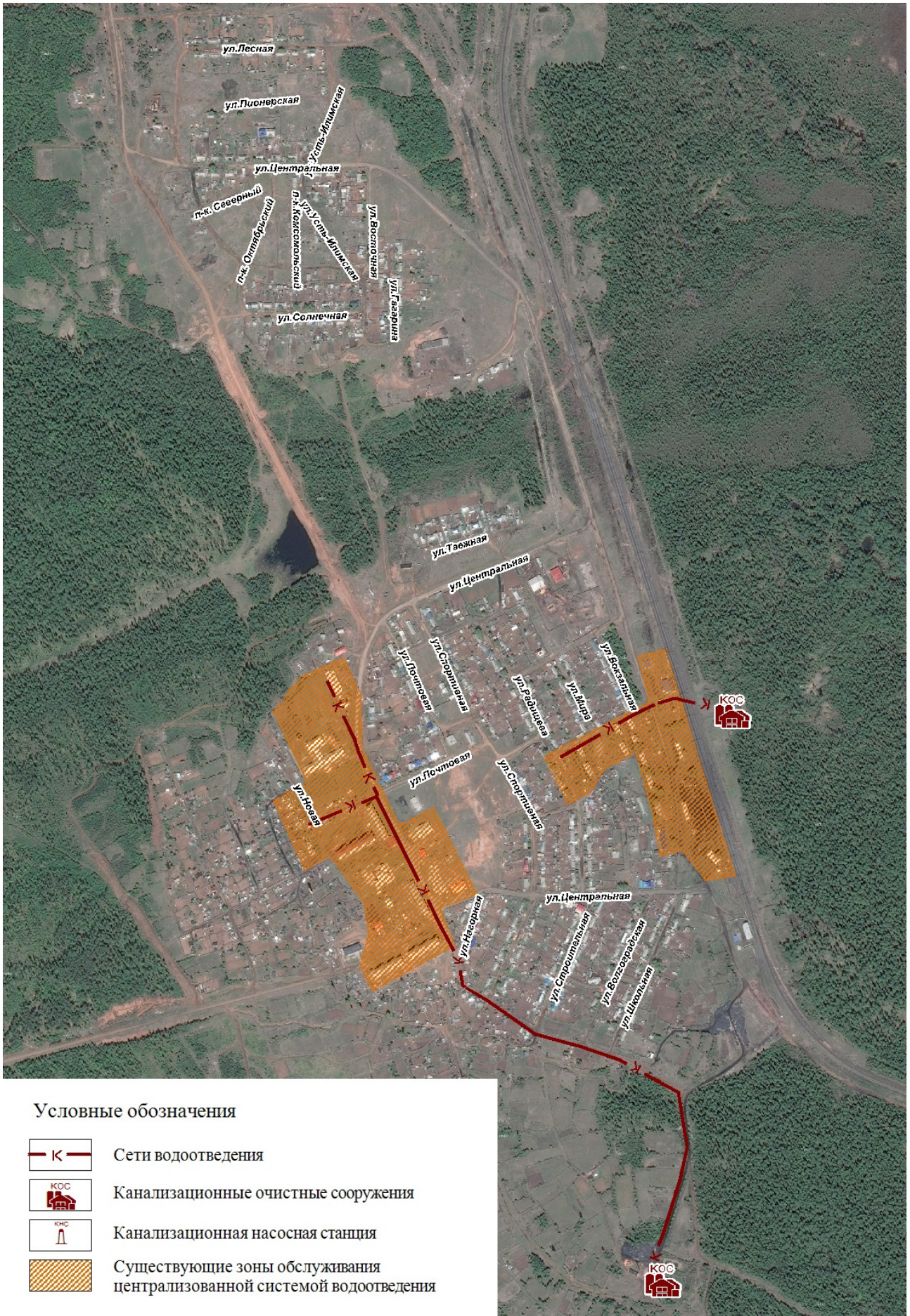
Рисунок 6 - Технологическая зона водоотведения с указанием зоны обслуживания централизованной системы водоотведения п. Тубинский
