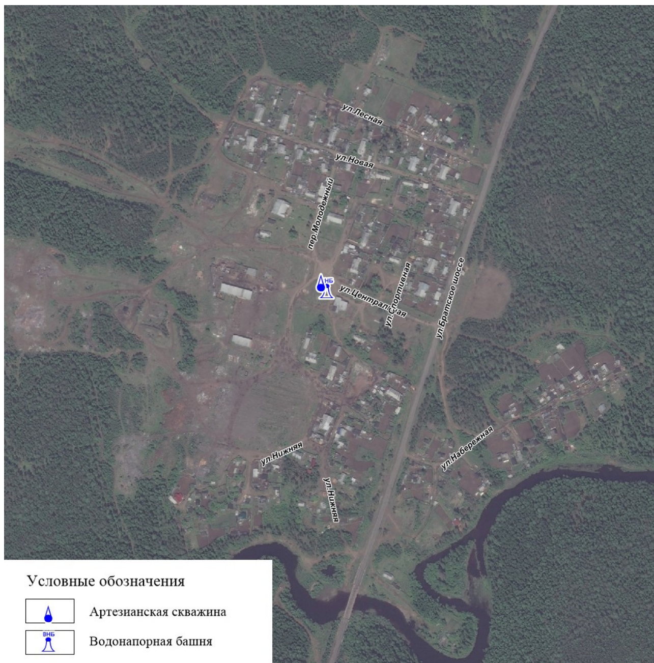
Рисунок 5 - Технологическая зона водоснабжения с указанием зоны обслуживания децентрализованной системы водоснабжения п. Бадарма
