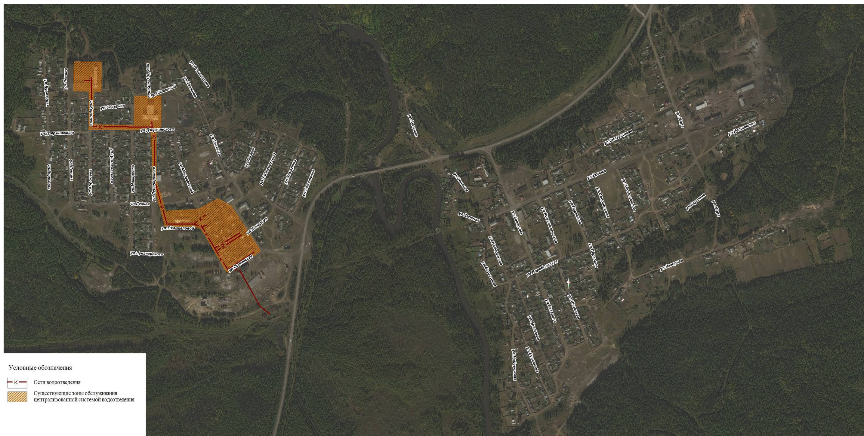
Рисунок 7 - Технологическая зона водоотведения с указанием зоны обслуживания централизованной системы водоотведения п. Эдучанка
