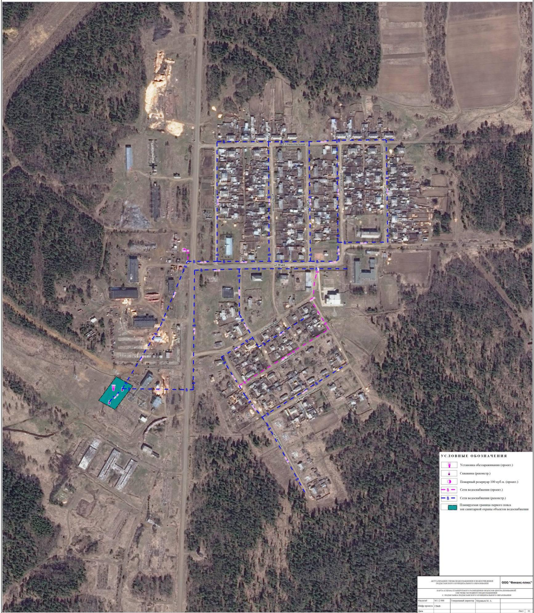
Рисунок 6 – Схема водоснабжения Подъеланского сельского поселения (проектное положение)
