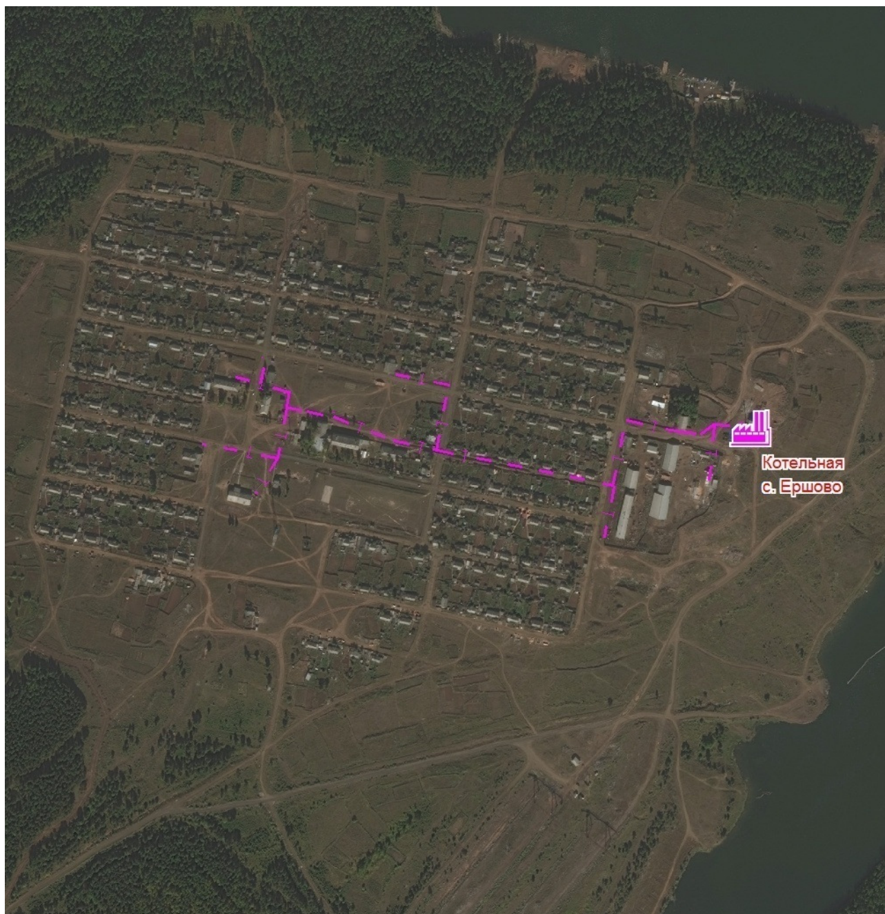
Рисунок 2 – Схема реконструируемых сетей теплоснабжения и реконструируемой котельной с. Ершово
