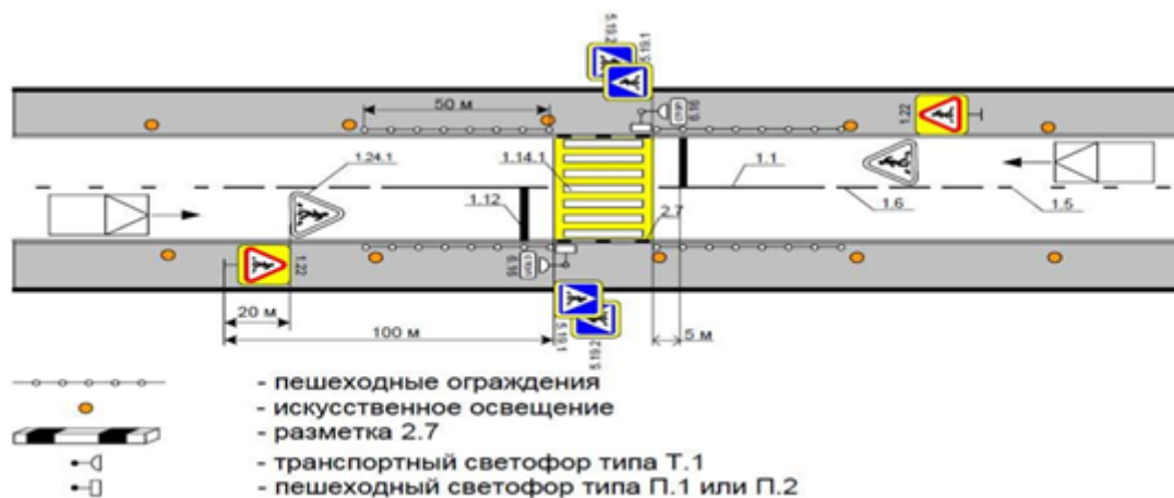
Рисунок 7 – Оборудование пешеходного перехода
