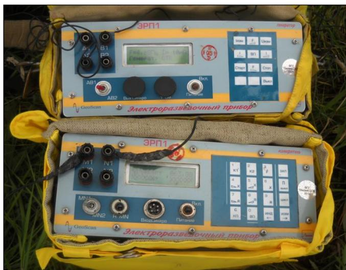
Рисунок 1 – Электроразведочная станция ЭРП-1.
