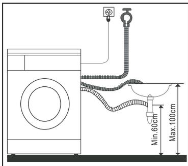
**Примечание:** фиксируйте шланг должным образом, чтобы он не был погружен в воду, чтобы вода не попадала на поверхность пола. Если шланг сброса воды слишком длинный, не пытайтесь засунуть часть шланга внутрь стиральной машины, т.к. это может создавать шум во время работы. Не рекомендуется использовать удлинительные шланги. При необходимости, удлинение должно иметь такой же диаметр, что и оригинальный шланг, и его длина не должна превышать 150 см.
