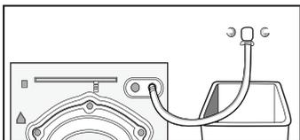
2. Подсоедините другую часть шланга в отверстие для водоотвода на задней стенке стиральной машины и закрутите туго по часовой стрелке (см. рисунок 2).
