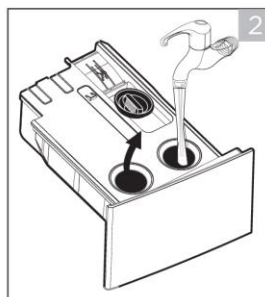
Очистите камеру дозатора и крышку смягчителя под струей воды
