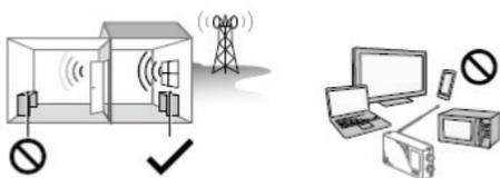
Старайтесь располагать приемник в месте с сильным сигналом. Не устанавливайте приемник вблизи источников сильного электромагнитного излучения (телевизор, микроволновая печь, компьютер, радиотелефон и т.п.).
