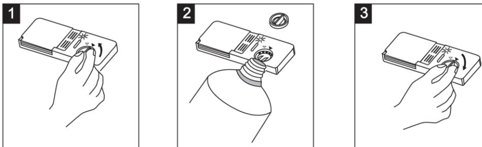
1. Чтобы открыть дозатор, поверните крышку против часовой стрелки (налево) и поднимите ее.
