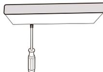
2. Извлеките рассеиватель с помощью отвертки
