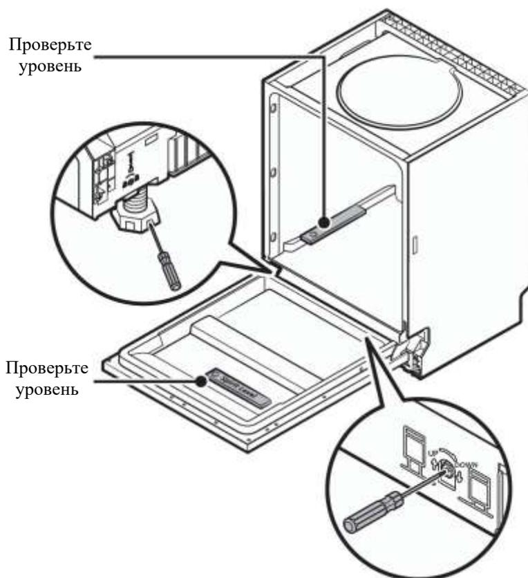
Максимальная высота регулировки ножек составляет 50 мм.
