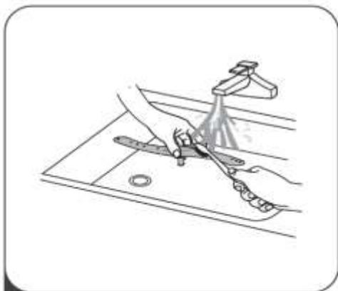
3 Используйте мягкую щетку для очистки форсунок распылителей, после очистки установите их на место.
