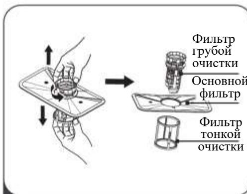
2 Фильтр тонкой очистки можно снять с нижней части фильтра. Фильтр грубой очистки можно отсоединить от главного фильтра аккуратно сжимая язычки в верхней части.
