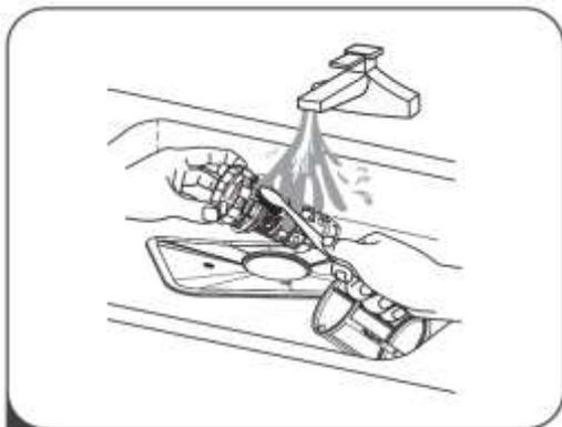
3 Крупные остатки пищи могут быть очищены путем промывки фильтра под проточной водой. Для более тщательной очистки используйте мягкую щетку.
