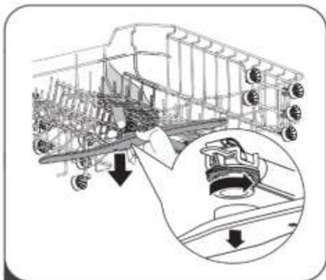
1 Чтобы снять верхний распылитель, удерживайте гайку и поверните рычаг по часовой стрелке, чтобы снять его.
