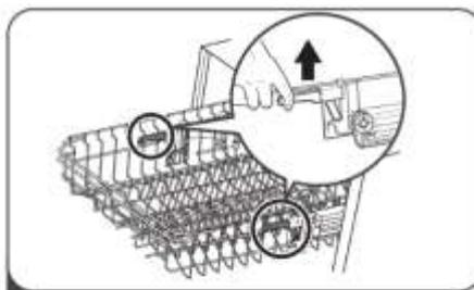
2 Чтобы опустить верхнюю корзину, поднимите специальные фиксаторы с двух сторон и приведите корзину в нижнее положение.
