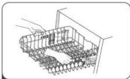
1 Чтобы поднять верхнюю корзину, просто потяните ее в центре каждой стороны, пока корзина не зафиксируется в верхнем положении.
