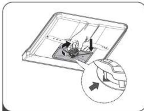
4 После очистки, соберите части фильтра в обратном порядке. Установите фильтр в место крепления и поверните по часовой стрелке до его фиксации.
