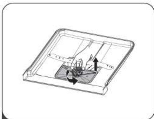
1 Возьмитесь за фильтр грубой очистки и поверните его против часовой стрелки, чтобы разблокировать. Поднимите фильтр вверх и выньте его из места крепления.
