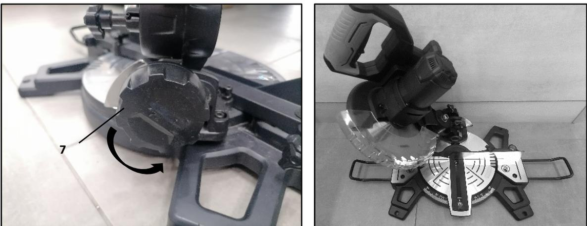
Ручка фиксации угла наклона пилы (7) используется для установки пильного диска на определенный угол наклона. Можно установить угол наклона пильного диска от 0° до 45° влево. Для установки угла наклона пильного диска ослабьте ручку фиксации угла наклона пилы и установите рукоятку пилы на желаемый угол наклона (См. рис.).
