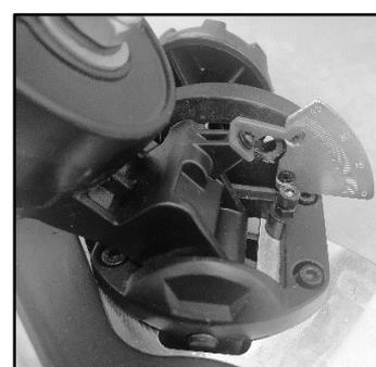
Пильный стол установлен на отметке от  $0^\circ$  до  $45^\circ$ , а пильный диск установлен под углом от  $0^\circ$  до  $45^\circ$  (См. рис.).
