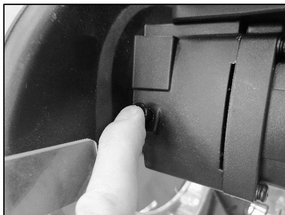
Кнопка фиксатора шпинделя **(19)** не позволяет пильному диску вращаться. Нажмите и зафиксируйте кнопку фиксатора шпинделя во время установки, замены или снятия пильного диска (См. рис.).
