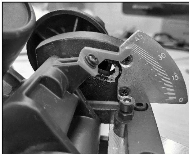
Пильный стол установлен на нулевой отметке  $0^\circ$ , а пильный диск установлен под углом от  $0^\circ$  до  $45^\circ$  (См. рис.).
