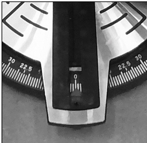
**Для выполнения поперечного пиления под углом 90° пильный стол должен быть установлен на отметке 0° (См. рис.).**
