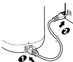
Подключите один конец сетевого шнура к соответствующему разъему на корпусе чайника-термоса (1), а вилку сетевого шнура – к электрической розетке
