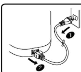
Отключите сетевую вилку от электрической розетки (1), а затем отсоедините сетевой шнур от чайника-термоса (2).
