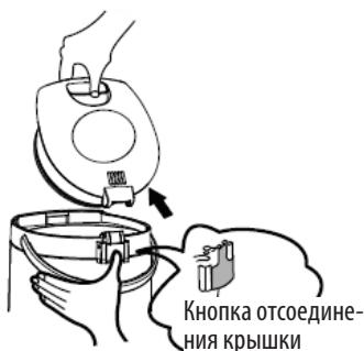
Нажмите кнопку отсоединения крышки и потяните крышку вверх, чтобы ее снять.
