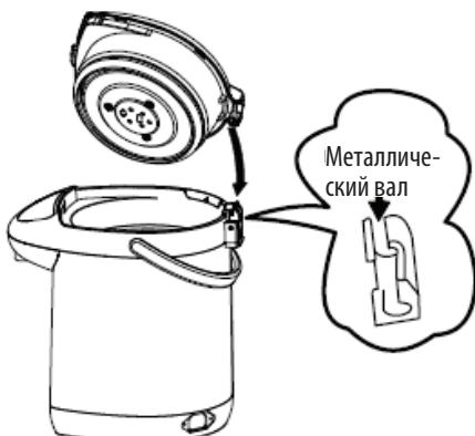
Закрепите металлический вал в соответствующем пазу крышки, чтобы ее установить.
