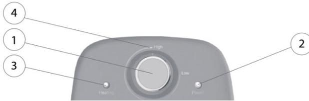
**Рисунок 2. Механическая панель управления, где 1 – механический регулятор нагрева, 2 – контрольная лампа «Power» для обозначения включения/выключения водонагревателя, 3 – контрольная лампа «Heating» для обозначения нагрева, 4 – температурная шкала.**
