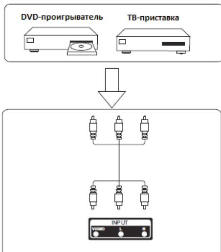
Чтобы подключить DVD-проигрыватель к композитному видеовходу телевизора, композитным видеокабелем соедините разъемы композитного аудиовideoхода телевизора AV IN с композитным видеовыходом DVD-проигрывателя.
