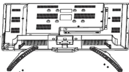
Найдите подходящую устойчивую поверхность и покройте ее мягкой тканью. Положите телевизор на подготовленную поверхность ЖК-экраном вниз.
