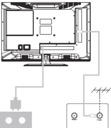
Подключите кабель питания к соответствующему разъему на задней стенке телевизора. Вилку кабеля питания подключите к электросети 100-240В, 50/60 Гц. Телевизор будет находиться в режиме ожидания.
