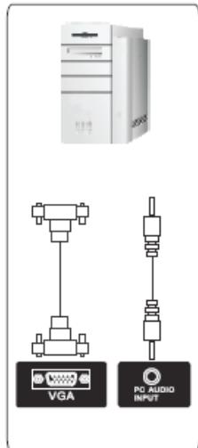
Подключите один конец кабеля VGA к разъему VGA компьютера, а другой конец кабеля VGA при соедините к разъему VGA телевизора. Тщательно, но с разумным усилием, затяните все винты крепления разъемов по часовой стрелке на каждом из концов VGA-кабеля. Аудиовход PC AUDIO INPUT телевизора соедините с аудиовыходом звуковой карты ПК. Сначала подключите к электросети компьютер, а затем телевизор.
