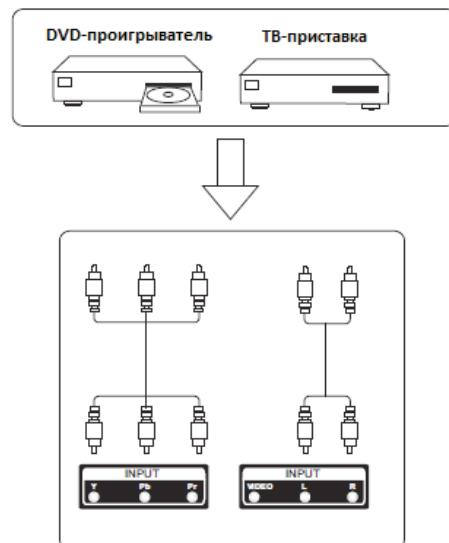
Чтобы подключить DVD-проигрыватель к компонентному видеовходу телевизора, компонентным видеокабелем соедините цветные разъемы компонентного видеовхода телевизора YPbPr с компонентным видеовыходом DVD-проигрывателя.
