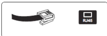
С помощью сетевого кабеля подключите телевизор к домашней сети и интернету.
