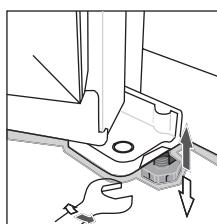
Если холодильник не выровнен, это может повлиять на работу дверцы и магнитных уплотнителей и, как следствие, привести к неправильному функционированию холодильника. Чтобы двери могли закрываться самостоятельно, холодильник нужно устанавливать под наклоном назад примерно в **10 мм**.
