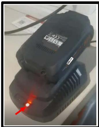
• **Немигающий КРАСНЫЙ индикатор на зарядном устройстве** указывает, что зарядное устройство начало цикл зарядки (Рис.11).
