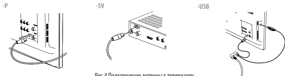
Рис.4 Подключение антенны к телевизору
