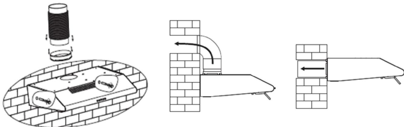
4. С помощью гибкой трубы соответствующего диаметра, соедините идущую в комплекте с устройством, с вытяжкой, другой конец присоединить к вентиляционной трубе (если таковая имеется).
