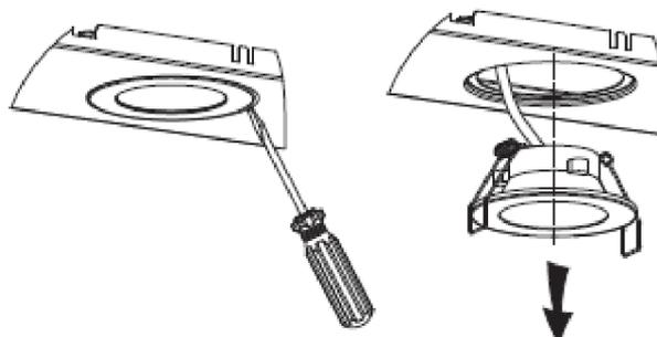
6. Вставьте лампу в вытяжку в обратном демонтажу порядке. Подключите проводку лампы.
