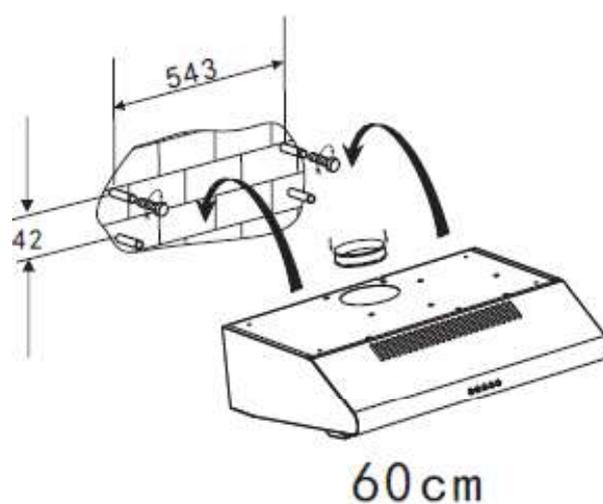
3. Подсоедините к выходному отверстию трубу вентиляции.
