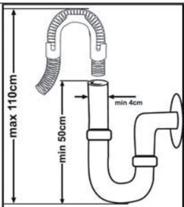
Сливной шланг можно подсоединить непосредственно к отверстию водостока или сливной трубе раковины. Это соединение должно находиться на расстоянии минимум 50 см и максимум 110 см от пола, на котором установлена посудомоечная машина.
