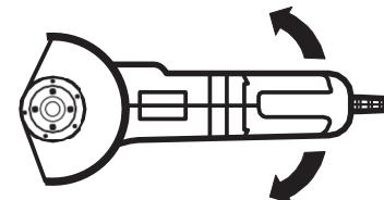
Изделие с раскручивающимся или останавливающимся диском обладает повышенным боковым крутящим моментом. Не выпускайте его из рук при запуске и выключении до полной остановки диска
