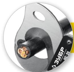
Рез кабеля с ленточной броней
