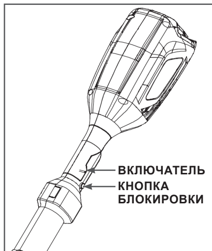
Рис. 9 Расположение органов управления на задней рукоятке
