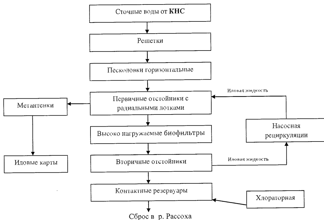
Рис. 1 — Схема работы городских очистных сооружений
